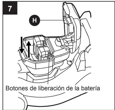
**AVISO:** al colocar el paquete de baterías en la herramienta, asegúrese de que la varilla elevada del paquete de baterías se alinee con la ranura de la herramienta y que los pestillos encajen en su lugar adecuadamente. El ensamblaje inadecuado del paquete de baterías puede provocar daños a los componentes internos.
