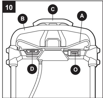
Para usar el sistema de autopropulsión sin rotación de la cuchilla, presione el gatillo de autopropulsión (D) hacia la manija.
