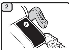
Coloque la palanca del estrangulador en la **Posición 1 (arranque)**.
